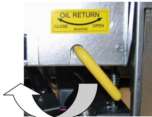
Permite que o óleo borbulhe durante 10-15 segundos de modo a garantir a evacuação de todo o óleo nas linhas de refluxo e rode o manípulo amarelo para a esquerda para desactivar a bomba.
