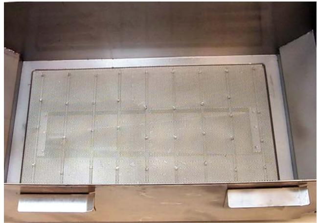
A grelha de suporte adequadamente colocada na panela de filtração.
