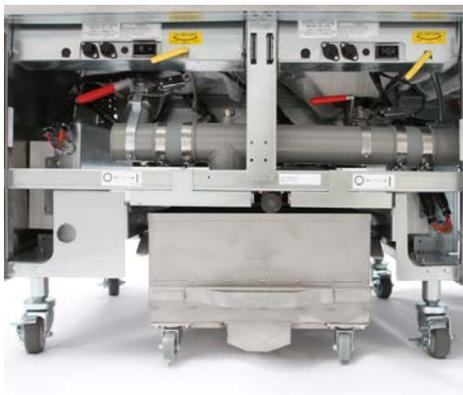
A panela de filtragem desliza sob a fritadeira (esquerda), ligando com um conector macho (direita). Certifique-se de que o tubo de absorção está fixado de forma segura com este conector. A sua localização pode variar com base no modelo.
