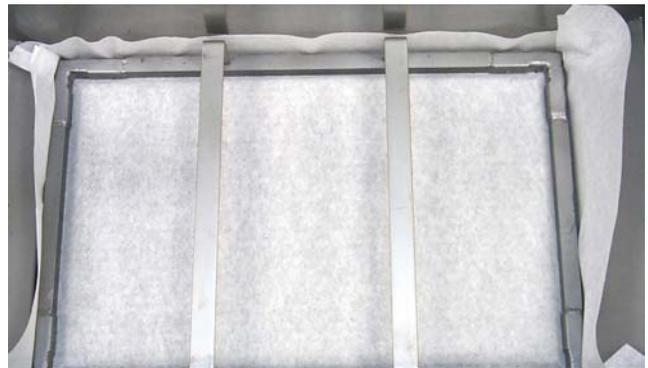
O anel de retenção correctamente posicionado sobre o papel de filtro na panela de filtração.
