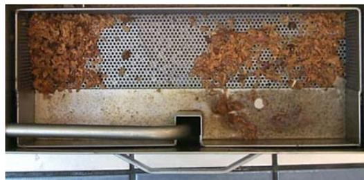
Esvazie a travessa de restos da panela de filtragem num recipiente à prova de fogo no final das operações de fritura de cada dia. NÃO PERMITA A ACUMULAÇÃO DE RESTOS NA TRAVESSA.
